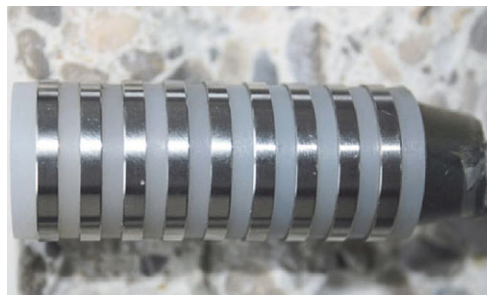
Bild 1 Drahtgebundene Multiringelektrode S+R Sensotec München
